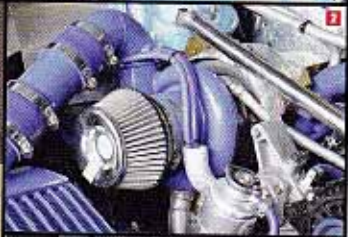
11 ストックのシャシーを補強し搭載された3ローターの20B。代表の雨宮さんが組み上げたエンジンで、サイドポートの拡大加工などが行われ、高ブーストにも耐えるセブミックアベックスシールが組み込まれる。吸気系に搭載されるのはケールカーという新熱などの効果を持つ電機。T8B-34Dを組み合わせた最大60kg/cm以上のトルクを発生。 12 エンジンの材質はモータースポーツのM800。レーシングワールドでも適用する高性能フルコンを使用し、
