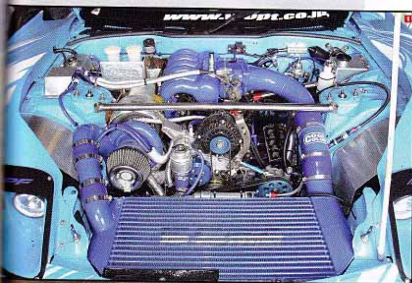
11 ストックのシャシーを補強し搭載された3ローターの20B。代表の雨宮さんが組み上げたエンジンで、サイドポートの拡大加工などが行われ、高ブーストにも耐えるセブミックアベックスシールが組み込まれる。吸気系に搭載されるのはケールカーという新熱などの効果を持つ電機。T8B-34Dを組み合わせた最大60kg/cm以上のトルクを発生。 12 エンジンの材質はモータースポーツのM800。レーシングワールドでも適用する高性能フルコンを使用し、
